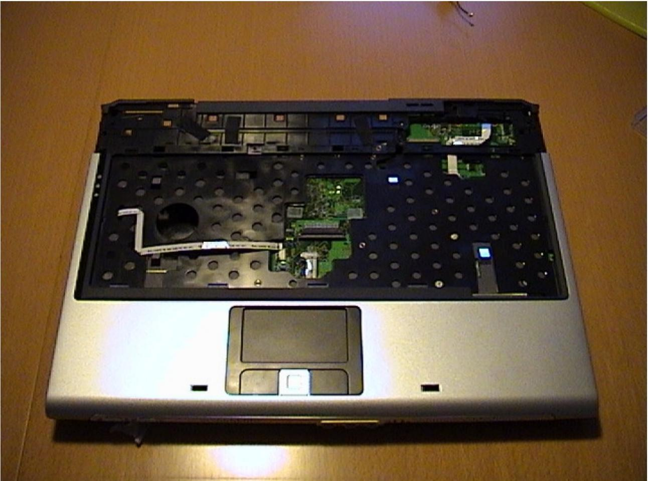
Abbildung 21: ohne Display, Tastenpanel, Tastatur
