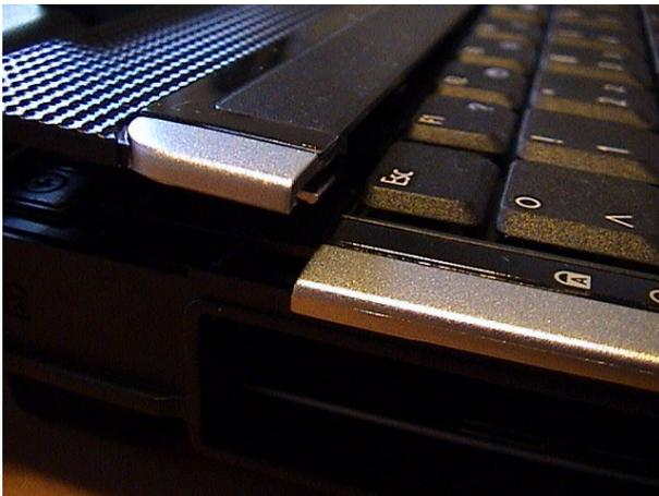
Abbildung 7: Abhebeln Tastenpanel
